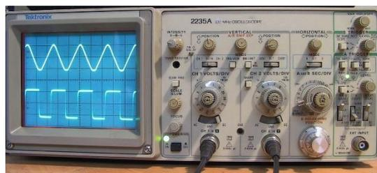
Un oscilloscope permet de visualiser simultanément les tensions produites par deux générateurs différents. Ci-dessus, on voit un générateur de tension sinusoïdale et un générateur de tension-créneau.
