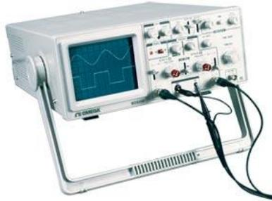
Ce dernier est constitué d'un tube à vide à l'intérieur duquel se déplace un faisceau d'électrons (particules porteuses de l'électricité négative).
