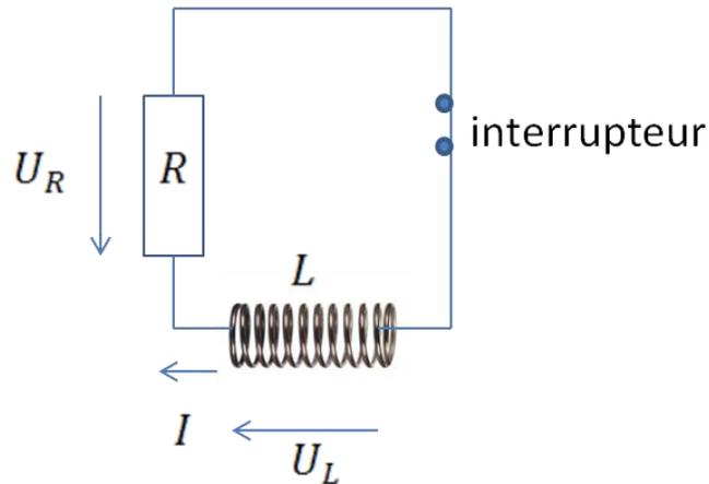
Cette fois-ci, la self étant parcourue par un courant  $I_{\text{max}}$ , on la laisse se décharger dans le circuit.
