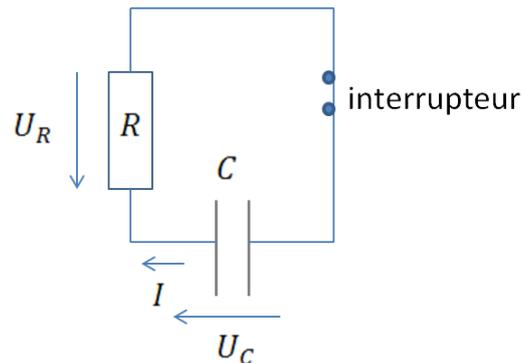
Cette fois-ci, le condensateur étant initialement chargé de charge  $q_{max}$  on ferme l'interrupteur et on laisse le condensateur se décharger à travers le circuit.
